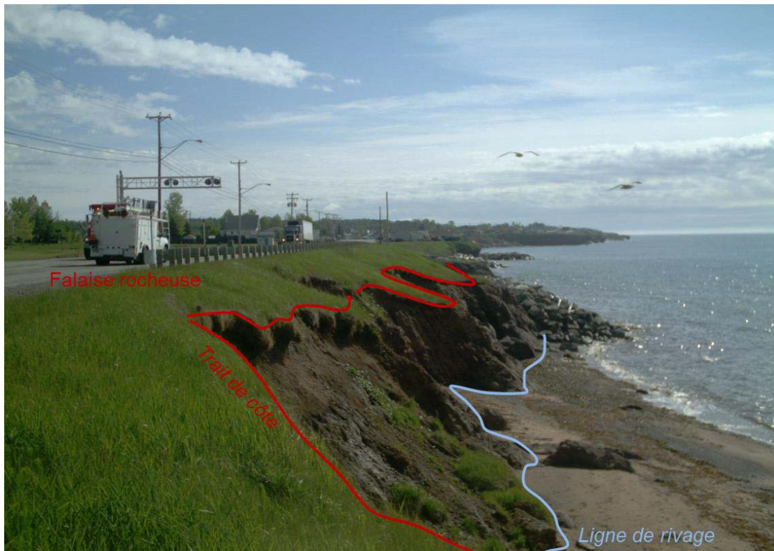
Limites géomorphologiques observées dans une côte à falaise rocheuse (exemple de Chandler)
